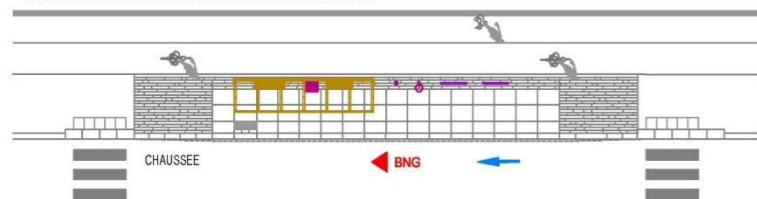
QUAI TYPE / QUAI TROTTOIR AVEC CHEMINEMENT ARRIERE
