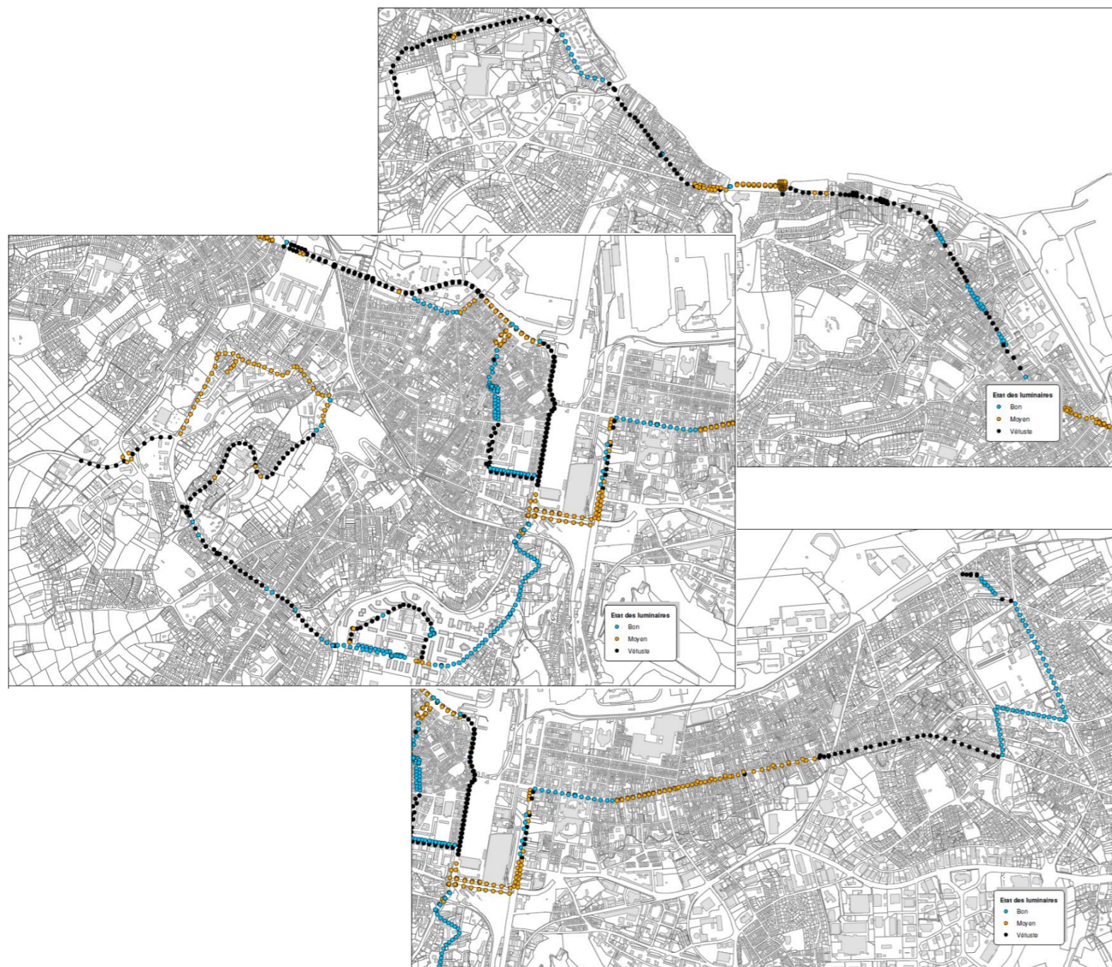
Cartographie des luminaires sur le tracé des lignes BNG
