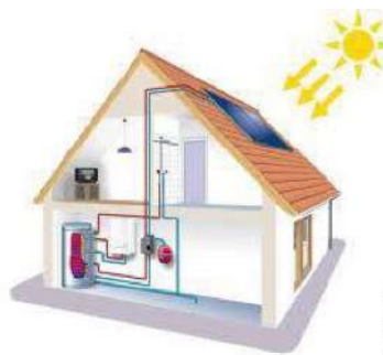
FIGURE 77. SCHÉMA DE PRINCIPE DE FONCTIONNEMENT DES CAPTEURS SOLAIRES THERMIQUES
